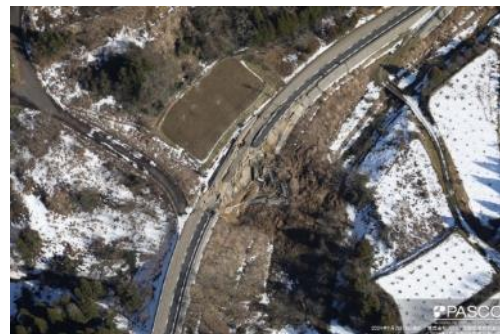
富山県 小矢部市 内山付近 法面が崩壊し、道路が陥没・寸
